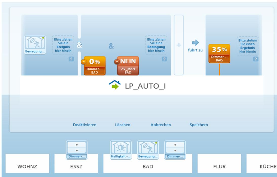
Sofern das Licht aus ist, und die ZV\_MAN nicht gesetzt wurde, führt eine Bewegungserkennung bei geringer Helligkeit zur Aktivierung des DIMmers auf 35 %.
