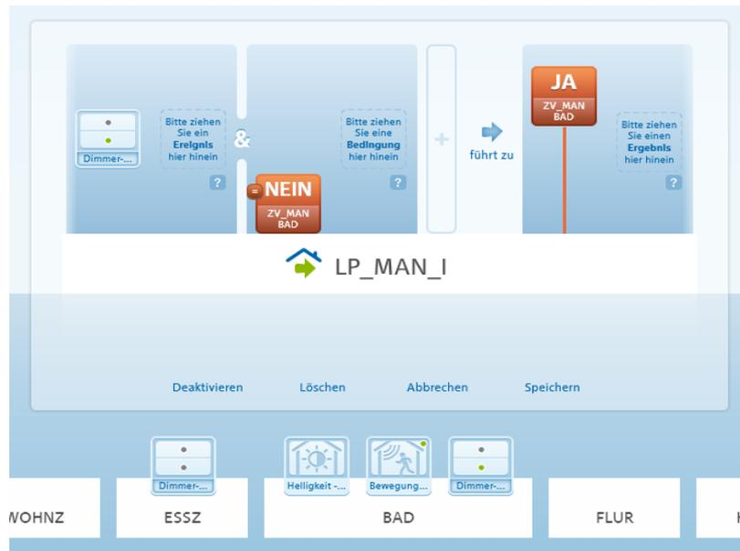
Sobald man den Taster AN betätigt, reagiert der DIM – Aktor (siehe das erste DIM\_T 2 Profil) und beeinflusst das Licht. Gleichzeitig wird die Zustandsvariable MAN (sofern inaktiv) auf Aktiv gesetzt. Der DIM Aktor fährt das Licht ggfs. auf 100 %.
